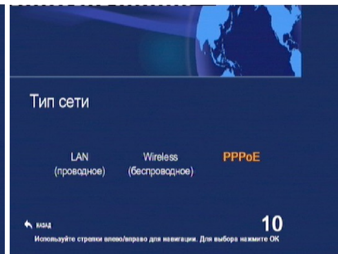
Изобр. 3.17: PPPoE для подключения к модему
